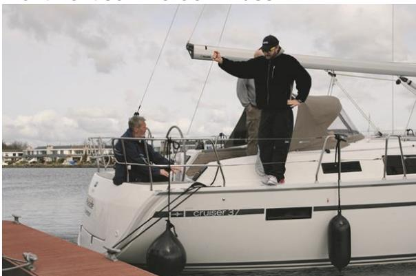
Schritt 4: Die Leine wird an Bord belegt und leichter Schub voraus gegeben
