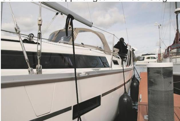
Schritt 7: Liegt das Schiff parallel am Steg, darf nicht ausgekuppelt werden. Erst wenn alle Leinen ausgebracht sind, kann ausgekuppelt und der Motor abgestellt werden.
