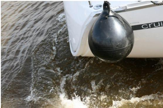
Das Heck bekommt einen Impuls zur Seite, wenn das Ruderblatt durch den Propeller angestrahlt wird
